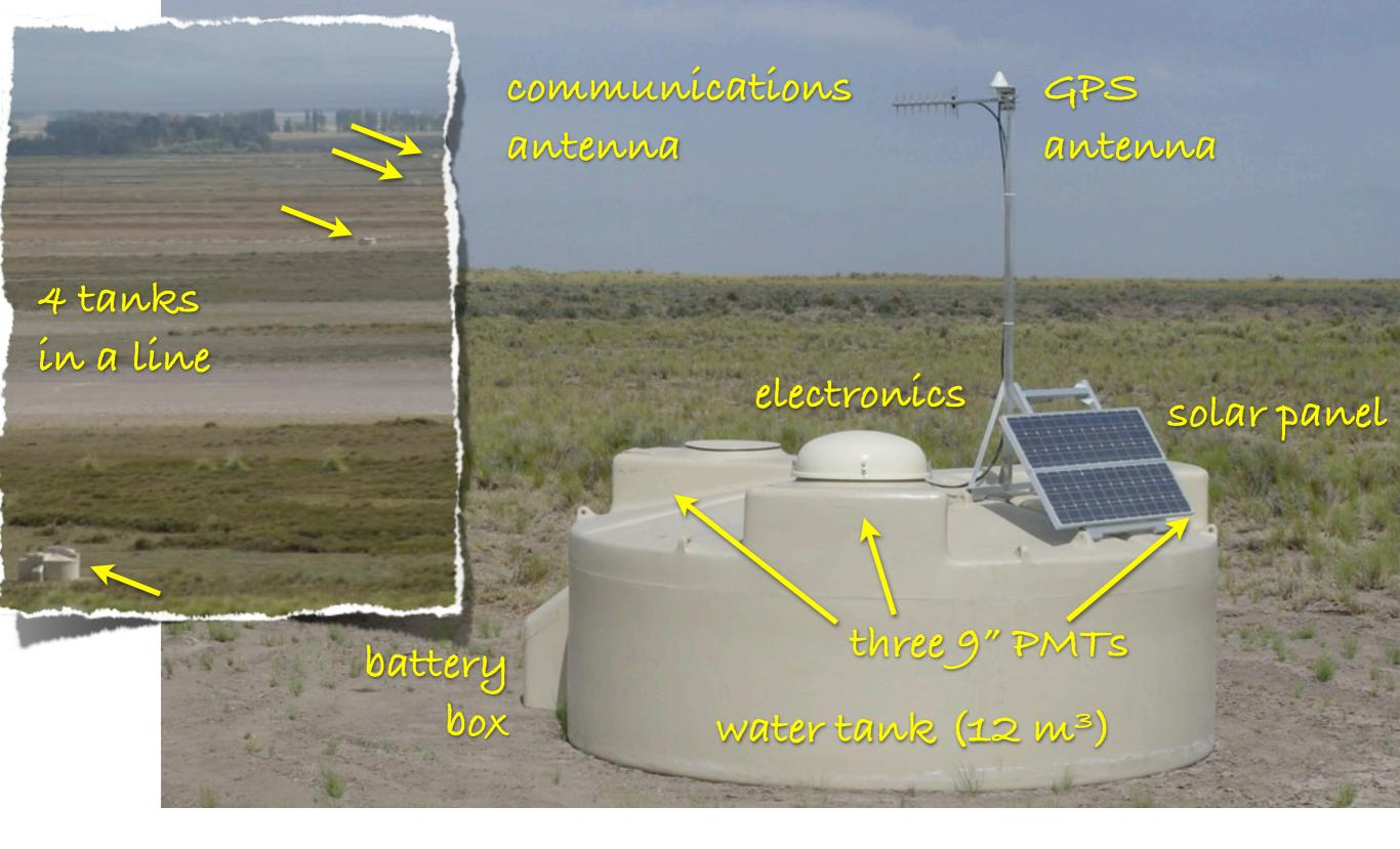
>1600 tanks deployed over 3000 km² tríangular gríd, 1.5 km dístance
